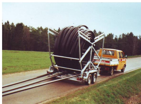
Abspulkörbe können auch ohne Anhänger als Standgerät verwendet werden. Gerätetransportanhänger eignen sich ebenfalls, allerdings muss eine sichere Befestigung gewährleistet sein.
