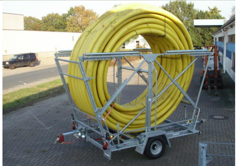
Es entsteht kein Druck auf das gesamte Rohrbund. Der Rollwiderstand ist geringer als bei herkömmlichen Lösungen. Es werden *keine Innenrollen* mehr benötigt und das innere Ende kann in das Bund gezogen werden. Die Variante BRVT 16 kann breitere Rohrbunde aufnehmen.
