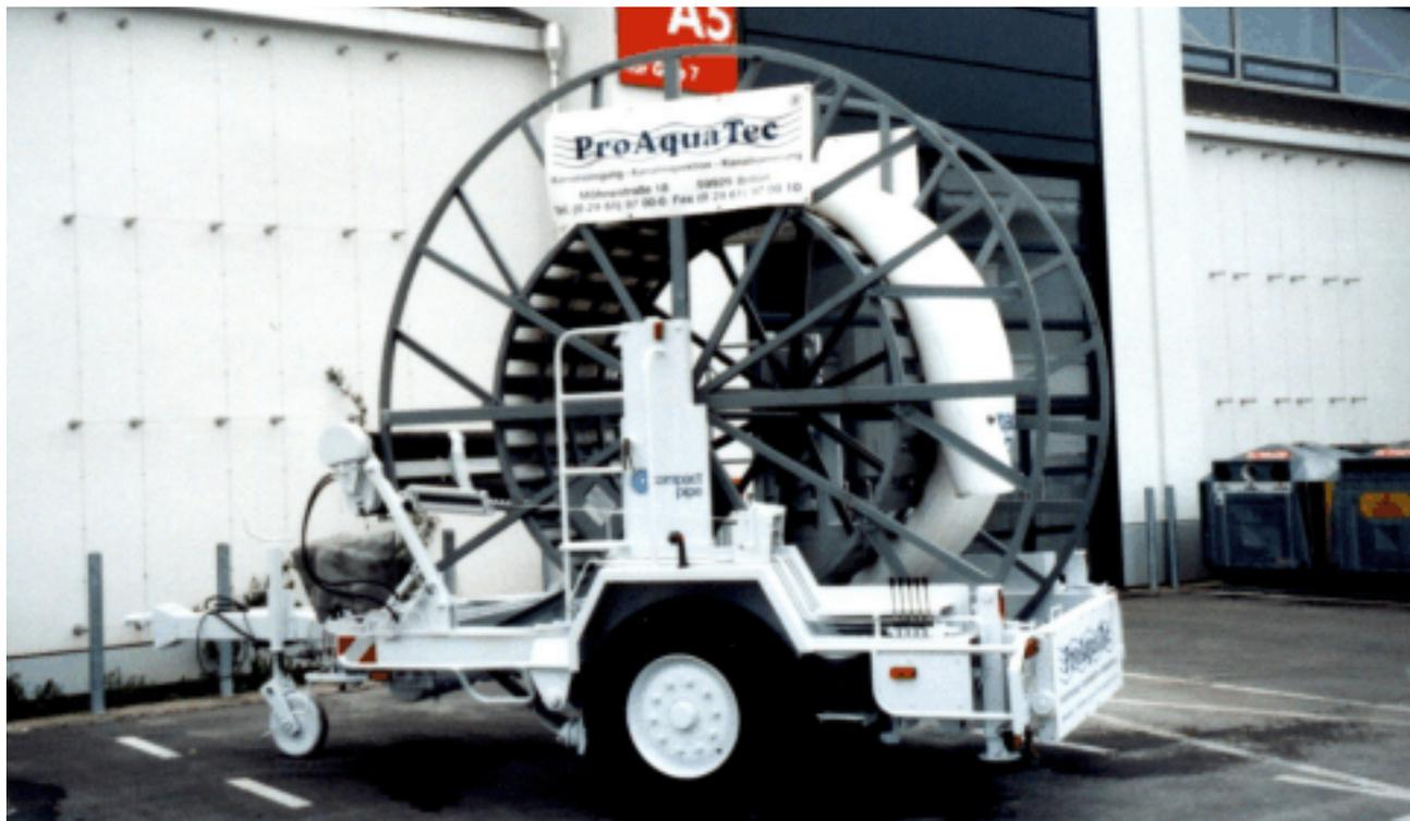
Um "Compact-Pipe" Inliner von 400 mm Rohrdurchmesser noch wickeln zu können, benötigt man Rohrtrommeln mit einem Außendurchmesser von 3700 mm. Für diese Anforderungen wurde der BRT 65 in nach hinten offener Bauweise gefertigt, die ein direktes Plazieren der Rohrtrommel in den Wagen ermöglicht.
