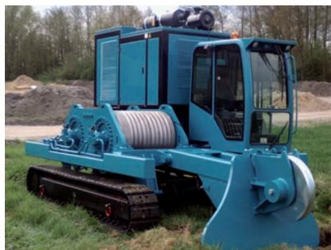
Die Windenaggregate bestehen hauptsächlich aus dem Doppelspilantrieb und der Seilspeichertrommel mit automatischer Wickelvorrichtung. Die gesamte Zugkraft wird dabei von einem Doppelrillenspillsystem erzeugt. Das geschlossene Stahlblechgehäuse ist schallgedämmt. Zur Bedienung wird lediglich die Abdeckung für die Windensteuerung aufgeklappt.
