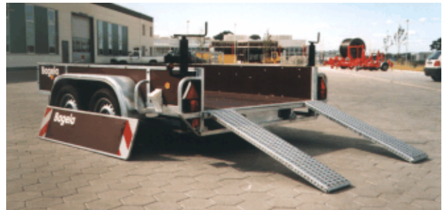
Seitlich verschiebbare Auffahrrampen auf einer Führungsschiene. Unterer Stauraum für Auffahrrampen.
