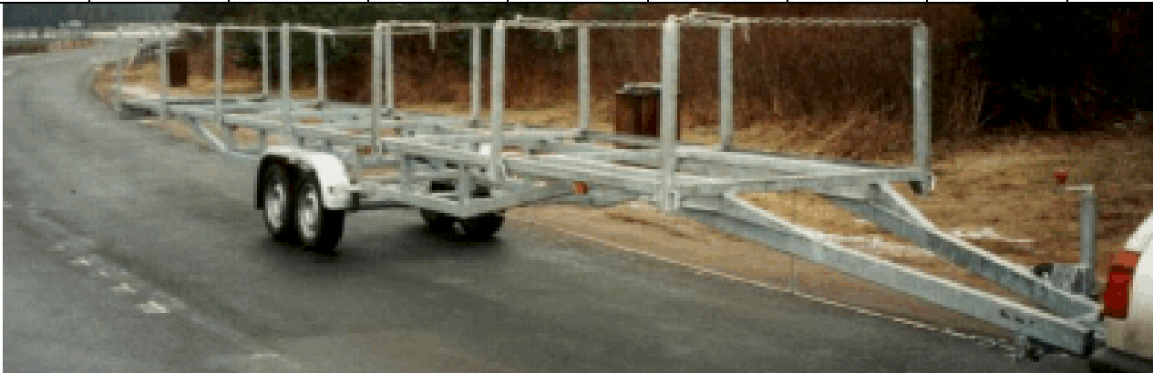
Stangentransportanhänger für den Transport von Langmaterial z.B. Rohre, Leitungsmaste
