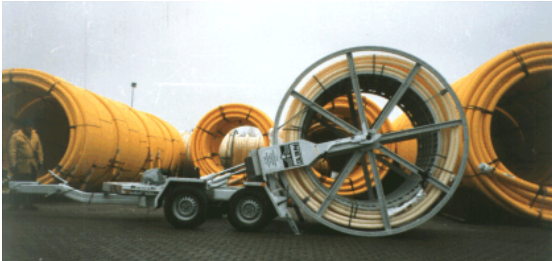
BRT 25 beim Aufnehmen einer U-Liner-Rohrtrommel
