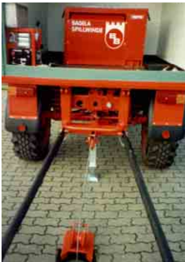
Bagela - Kabelziehwinde, aufgebaut auf Unimog, angetrieben vom Nebenantrieb
