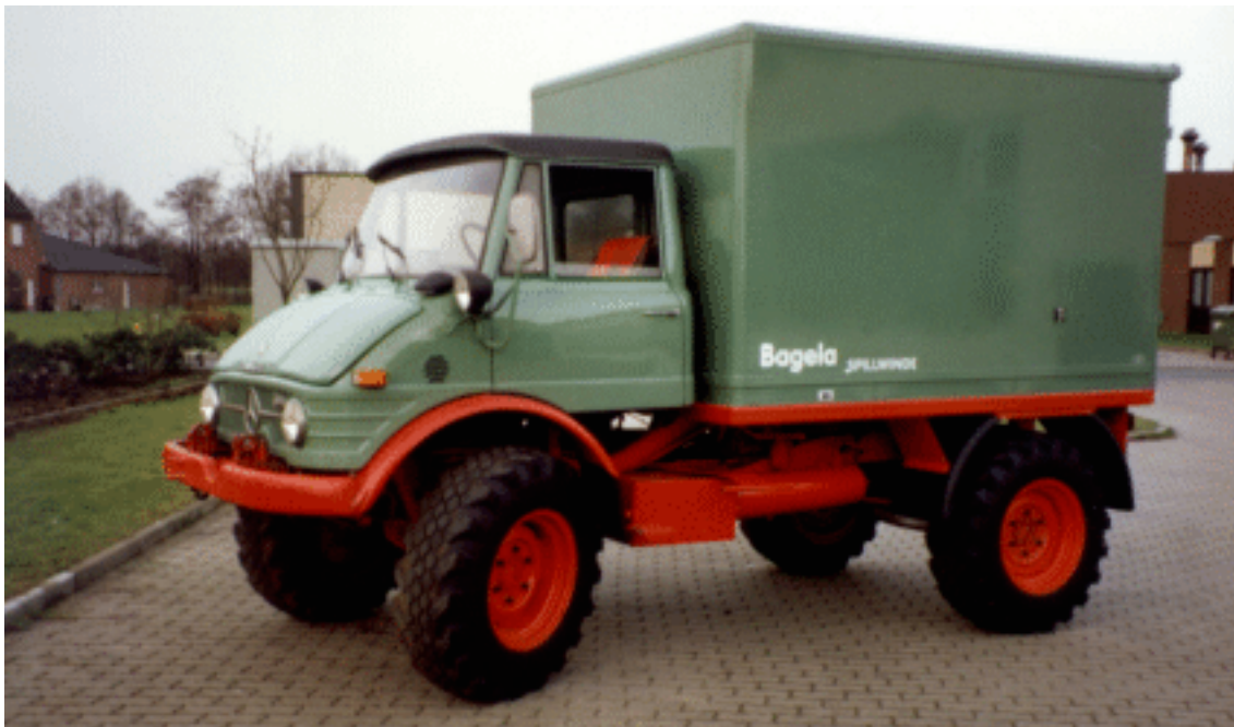
Bagela - Kabelziehwinde, aufgebaut auf Unimog, angetrieben vom Nebenantrieb
