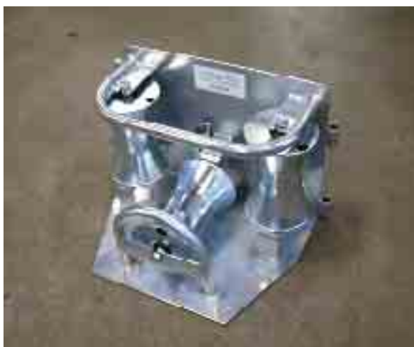
Kabeleckrolle mit Steckscharnieren , verzinkt mit staub- und spritzwassergeschützten Kugellagern Gewicht: 13,5 kg Bestell-Nr. 009.404.00
