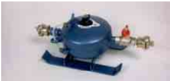
Nebelöler Dieses Gerät wird zwischen Kompressor und Luftschleuse des Kabeleinblasgerätes eingesetzt. Der Luftstrom reißt eine genau dosierbare Menge Gleitöl mit und bringt es als Ölnebel ins Rohr.
