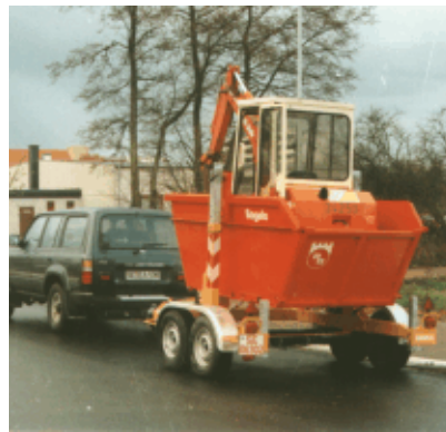
BKT 23 mit Container und Minibagger
