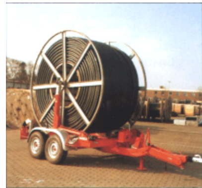
BKT 23 mit HDPE-Leerrohrtrommel
