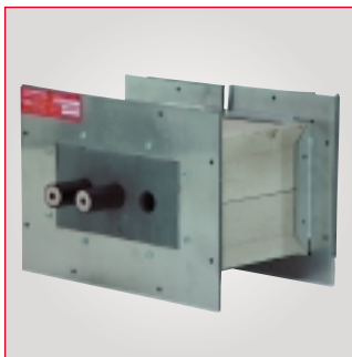
BS 90-SKR/100/1x1/L (BS 90 Schottkasten Zulassungs-Nr. Z-19.15-1230, Z-19.15-1346) Breite 100 mm, Höhe 100 mm (L=Wandstärke in mm; min. 100 mm) BS 90 Schottkasten mit Brandschutzfüllung als Installationseinheit für leichte Trennwände mit Rahmen.
