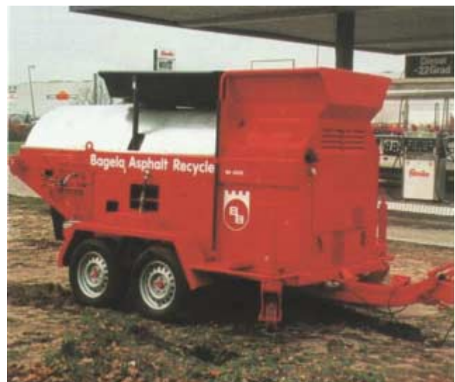
BA 7000 F beim Trocknen von Böden
