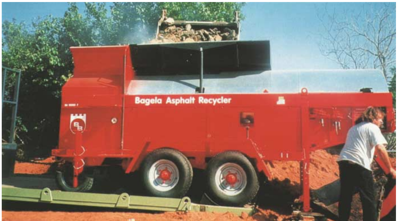
BA 10000 F beim Verarbeiten von Asphaltaufruch
