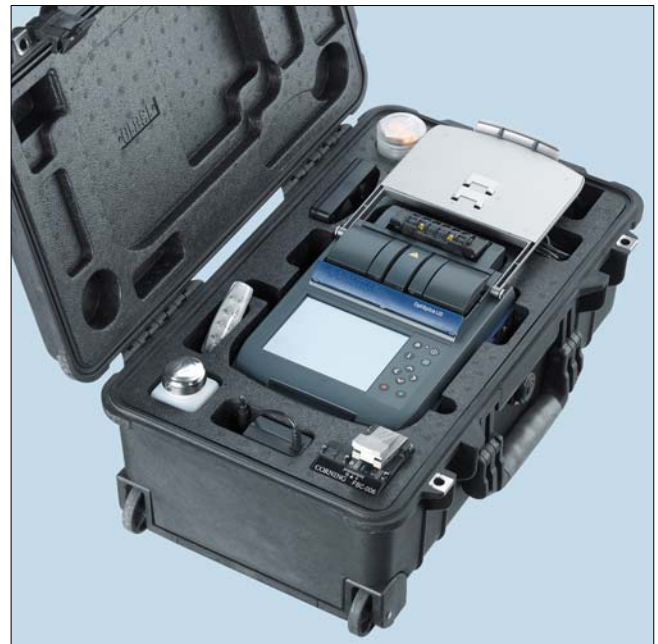
OptiSplice LID Spleißgerät im Transport- und Arbeitsstationskoffer
